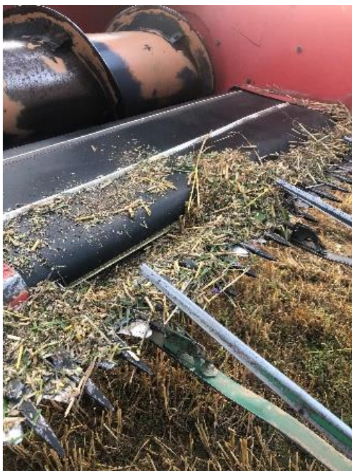
Abbildung 42: Blick auf das Schneidwerk nach dem Mähvorgang. Zwischen Schneidwerk und Förderband finden sich Ansammlungen von Halmbruchstücken, Ackerwildkrautsamen usw. Bildautorin: Natascha Lepp 2021
