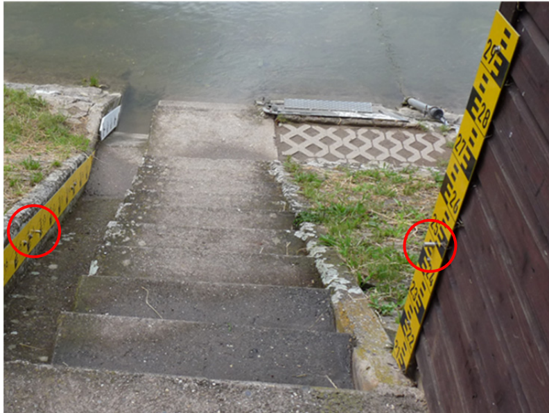
Bild 7: Rangendingen-Starzel: Angeschraubte Metall-Linsen auf einer Pegellatte (30.06.2016)
