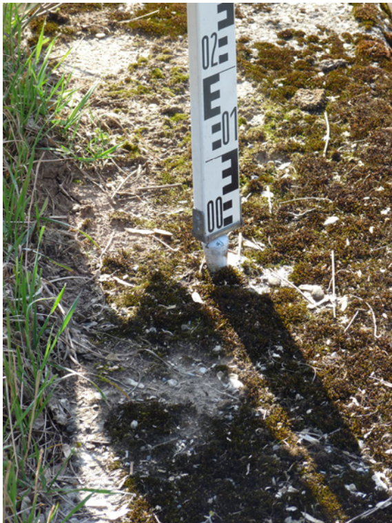
Bild 5: Positivbeispiel: Aufhalten einer Nivellierlatte auf einem Pegelfestpunkt
