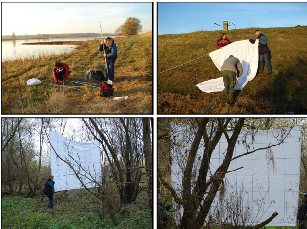
Abb. 37: Aufbau des Messrahmens: links oben: Verschrauben des Messrahmens, rechts oben: Aufziehen des Rasters, links unten: Transport des Rahmens im Gelände, rechts unten: Aufstellen des Rahmens hinter der Vegetation [aus: Schneider 2010]
