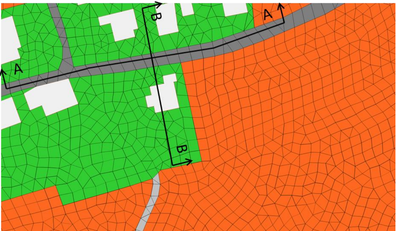
Abbildung 25: Detailausschnitt Simulationsnetz Seewalchen mit 5m Auflösung im gesamten Modellgebiet
