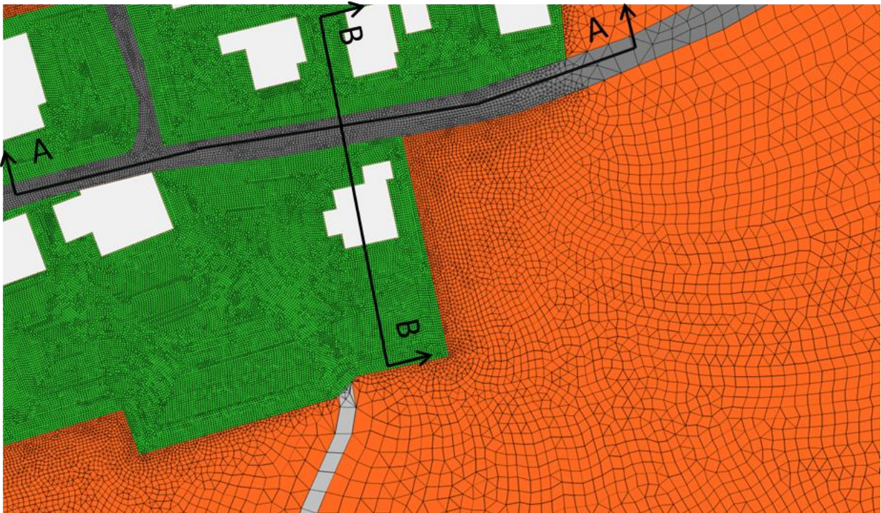
Abbildung 22: Detailausschnitt hochaufgelöstes Berechnungsnetz Seewalchen mit einer Auflösung von 0.5 m im Siedlungsbereich und 4 m in den Freilandflächen
