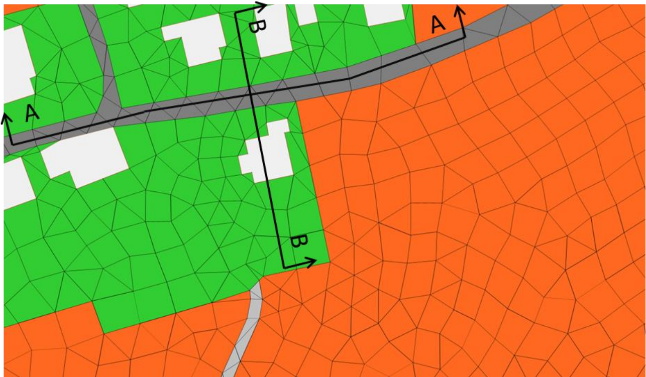
Abbildung 26: Detailausschnitt Simulationsnetz Seewalchen mit 10m Auflösung im gesamten Modellgebiet
