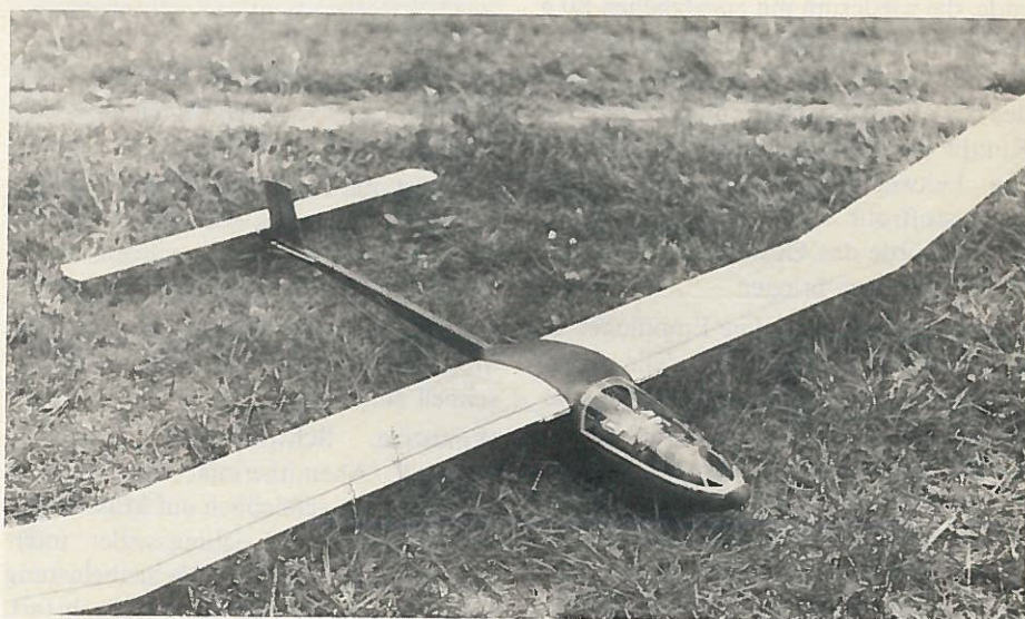
Der Vorgänger des RC-Sapers mit angelenktem Höhenleitwerk und einem schönen Rumpf mit Haube. Diese erste Version sah zwar schön aus, die Schönheit wog aber 300 g zuviel. Das Modell flog schlecht
