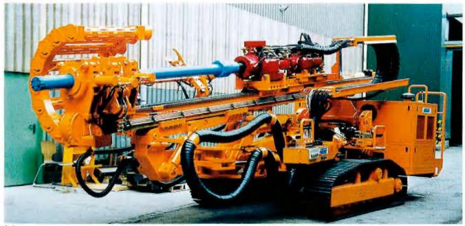
Ankerbohrgerät AN 160
