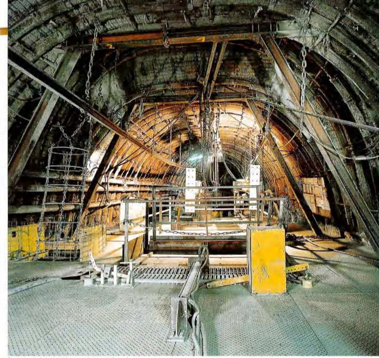
Bunkerkopf mit Schiebeklappe und "mlenkrollenverlagerung
