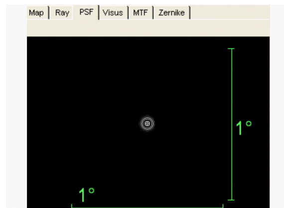
Abb. 6: PSF Sphärische Aberration
