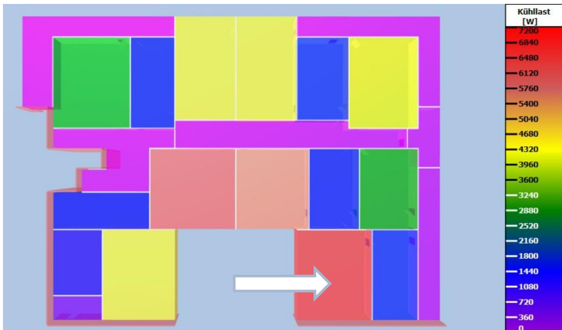
Abbildung 6-3: Raumkühllasten des Schulgebäudes (Obergeschoss)
