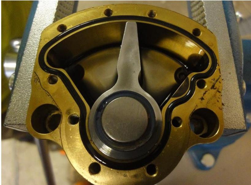
Abbildung 16 Ansicht auf einen geöffneten Rotations-Lenkungsdämpfer von Öhlins Abbildung nach [BEC18]
