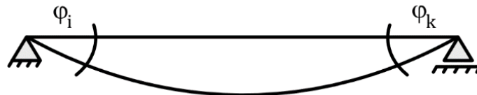
Abbildung 5.5 Verdrehwinkel der Endauflager eines EFT, nach [1]
