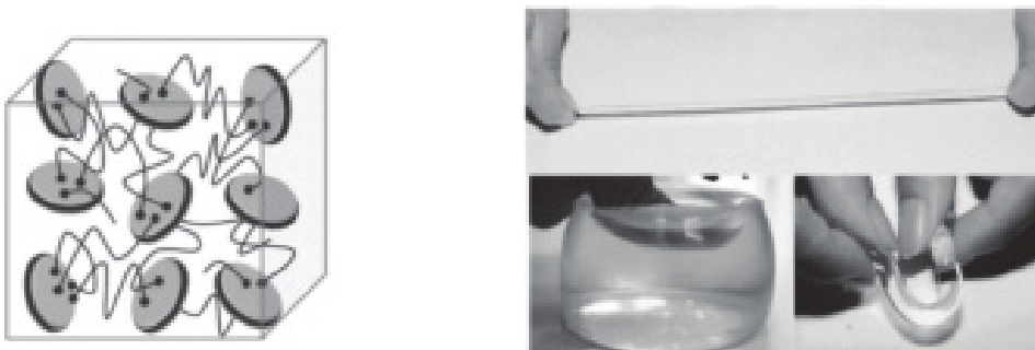
Abbildung 19 Modifikation von Polymeren mit Tonmineralien. Aufgrund der Schichtstruktur der einzelnen Kristalle wird eine Verbindung zwischen Polymerketten und den Tonmineralien möglich und die mechanische Stabilität und Belastbarkeit der Matrizen kann verbessert werden. Abbildung entnommen aus (70).
