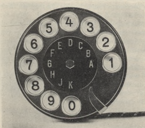
Fig. 3. Nummernscheibe der Deutschen Reichspost (Vorderansicht).
