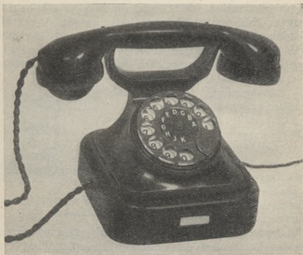
Fig. 9. SA-Tischapparat der Deutschen Reichspost.
