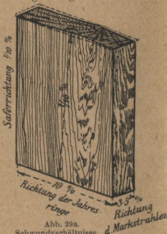
Abb. 28 u. 29. Schwinden eines Seitenbrettes und eines Kernbrettes.
