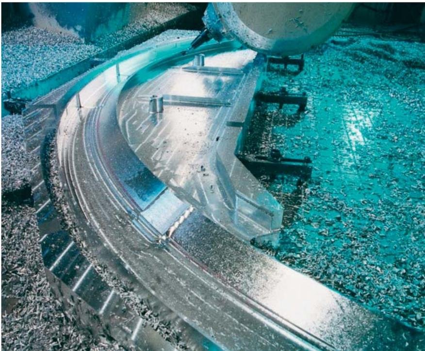
**Oberflächengüte:** Mit der CNC-Funktion APC (Advanced Position Control) lässt sich der KV-Faktor deutlich erhöhen. Wie die Praxis gezeigt hat, wird bei gleicher Oberflächengüte die mögliche Bearbeitungsgeschwindigkeit höher, die Bearbeitungszeit hingegen kürzer.
