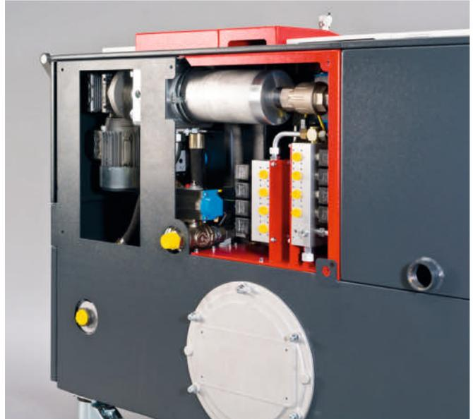
**3** Dank seitlichem Revisionszugang und durchdachter Anordnung im Innenraum sind sämtliche Komponenten gut zugänglich. Ebenfalls gut erkennbar: Selbst der hochwertige, innovative Automatikfilter konnte von den Müller-Konstrukteuren perfekt in die aktuellen Platzgegebenheiten integriert werden
