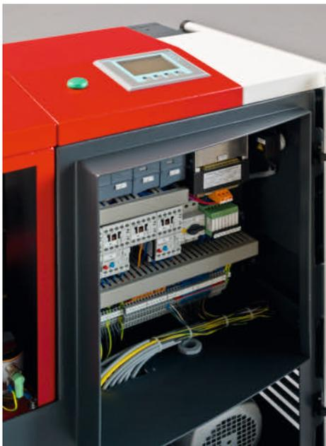
**2** Das Bedienpaneel der Combiloop CL3 ist leicht angeschragt und ergonomisch im Sichtfeld angebracht. Die Steuerung der Maschine erfolgt über den einfach bedienbaren, berührungsempfindlichen Bildschirm
