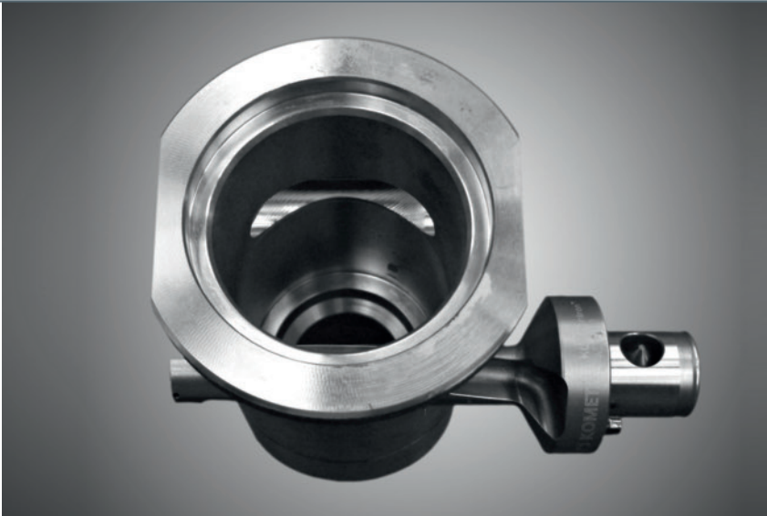
3 Mit dem Wendeschneidplattenbohrer Komet KUB Pentron können die Bohrungen in den Meißelhalterbuchsen von einer Seite in einem Arbeitsgang bearbeitet werden
