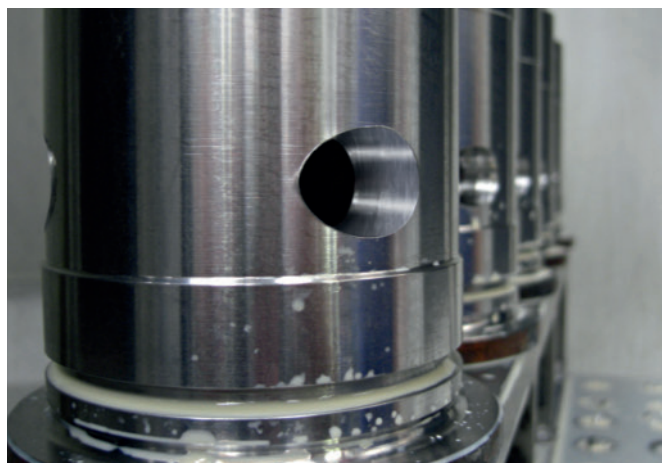
2 Schon beim Bohrungseintritt sorgt der schräge Anschnitt am Umfang des Werkstücks für abdrängende Kräfte
