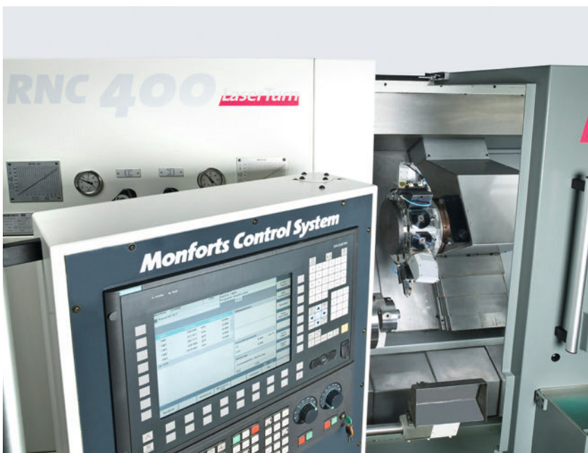
3 Das revolverintegrierte Laserwerkzeug bei der RNC 400 Laserturn ist auf einem Standard-Werkzeugplatz positioniert
