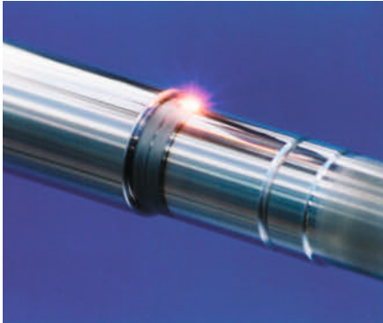
4 Auch zum Laserhärten lassen sich die Laserwerkzeuge in der RNC 400 Laserturn einsetzen, was in Kombination mit dem ...
