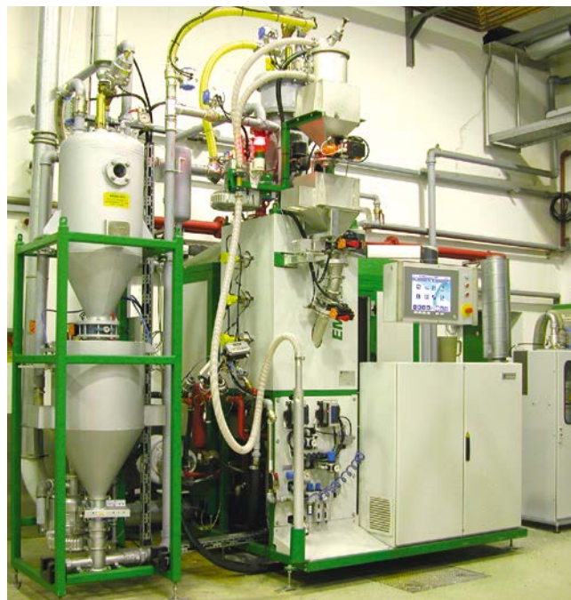
Bild 6. Modell des Vorschäumers ED2-HP mit gravimetrischer Einwaage
