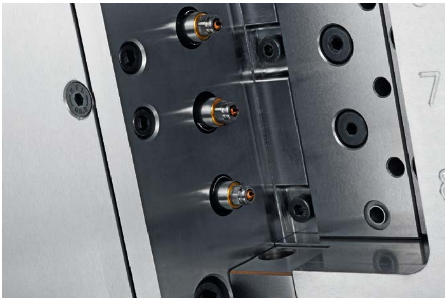
Die an VKF gelieferte Heiße Seite beinhaltet ein 8-fach Linearsystem mit seitlicher Anspritzung zur Verarbeitung eines verweilzeitkritischen Polycarbonats (© Witosa)
