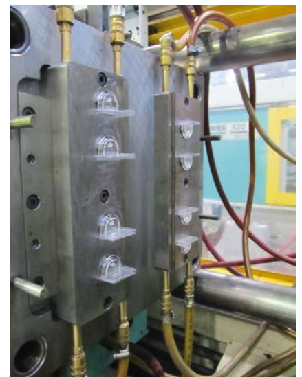
Spritzgussteile vor dem Entformen in der Auswerferseite. Auf der Heißen Seite lassen sich vier verschiedene Wechseleinsätze auf einfache Weise montieren (© Witosa)
