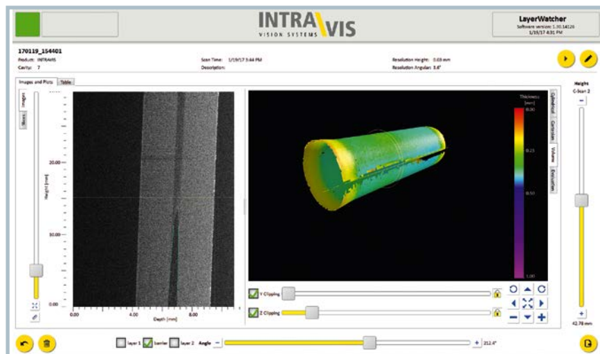
Nicht vollständig vorhandene Schichten können leicht in der 3D-Falschfarben-Visualisierung oder in der Graustufenansicht detektiert werden (© Intravis)
