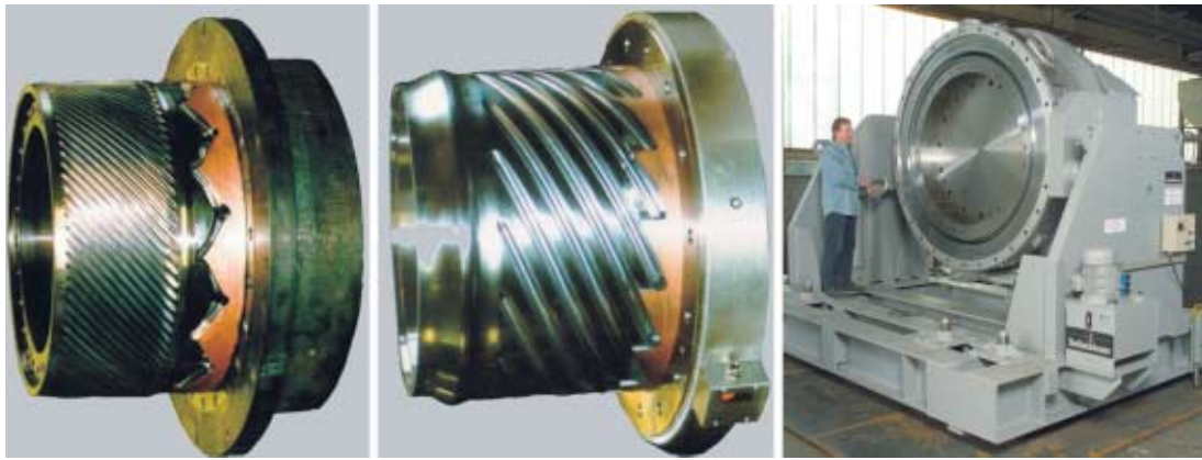
Bild 9. Wendelverteilerbauformen; links: Dorn mit Kleiderbügelvorverteiler, Mitte: Dorn mit Sternvorverteiler (Quelle: ETA); rechts: Werkzeug für Rohre mit Durchmessern bis 2000 mm
