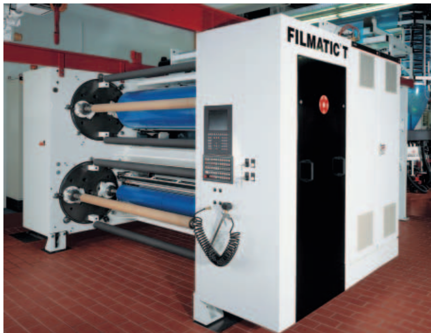
Bild 1. Platz sparender Universal-Wendewickler Filmatic T für alle Wickelarten, kleberloses Anwickeln und Drehrichtungsumkehr
