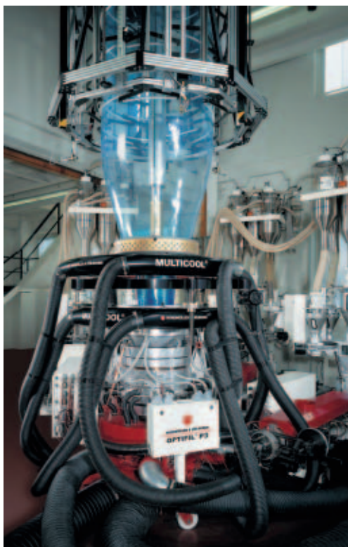
Bild 2. Varex 3-Schicht Coextrusionsanlage mit Optifil P3 für extrem hohe Durchsatzleistungen
