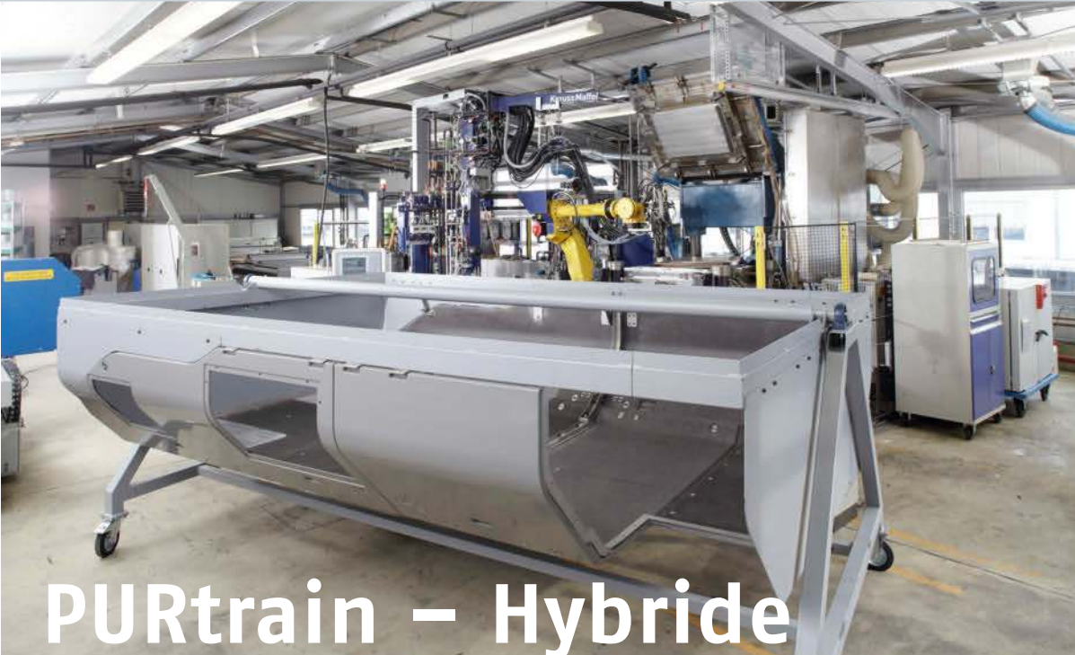
Technologiedemonstrator der selbsttragenden Dieselmotoreinhausung [14]
