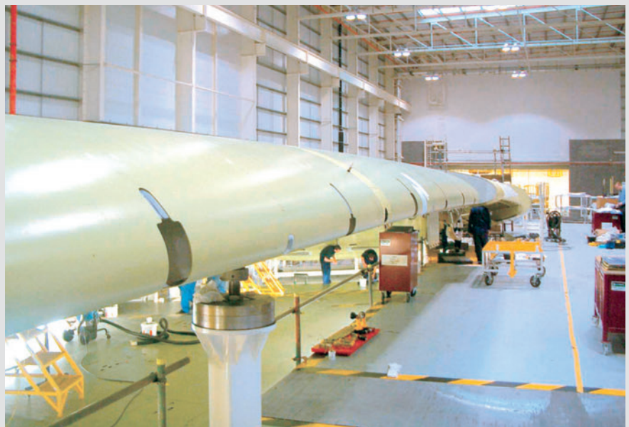
Bild 2. Produktion der Tragflächenvorderkanten des Airbus A380 bei Fokker Aerostructures in den Niederlanden. Die Basis für die Composite-Platten bilden Kohlenstofffasern und PPS
