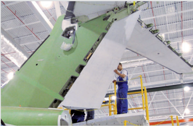
Bild 1. Mit der Gulfstream G650 heben zum ersten Mal in der Geschichte des Flugzeugbaus tragende Flugzeugteile aus thermoplastischen Composites ab
