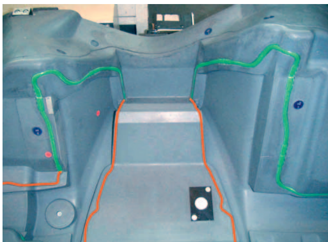
Bild 13. Durch Kombination der Dichtsysteme (rot: starre Dichtung, grün: aufblasbare Dichtung) erreicht man minimale Ausläufe und gute Entlüftung
