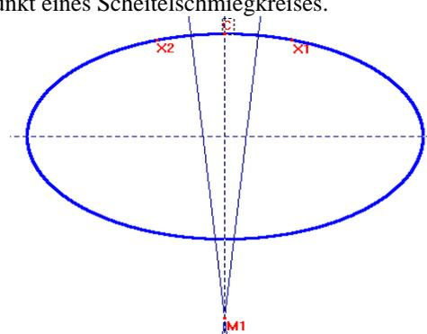
Analog ermitteln wir den Mittelpunkt eines Schmiegekrees in einem Hauptscheitel und zeichnen die Schmiegekrees. Durch Annäherung der Ellipsenpunkte an die Nebenscheitel erhalten wir die Schmiegekrees in den Scheitelpunkten der Ellipse.
