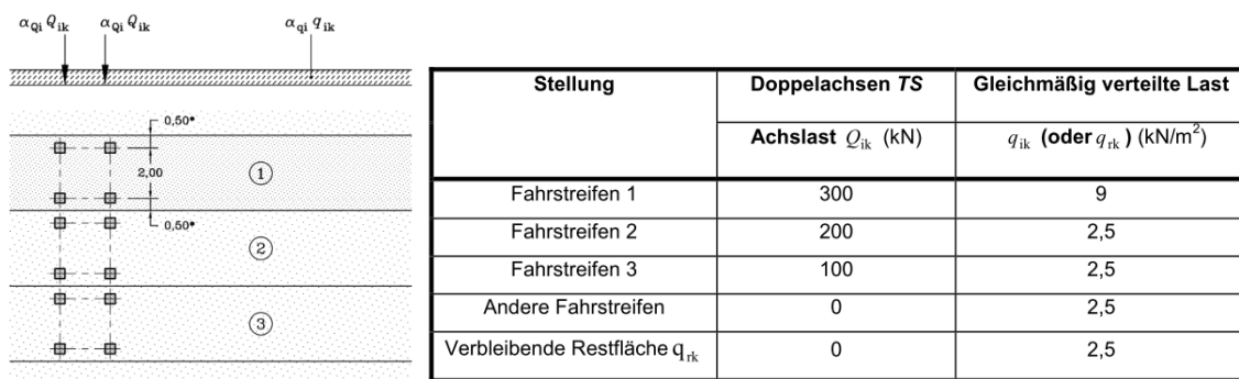
Abb. 2-3: Anordnung der Fahrstreifen und Doppelachsen sowie charakteristische Lastwerte nach [38]
