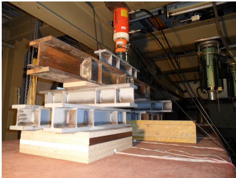
Abb. 6-3: Versuchsaufbau zur Lasteinleitung in die orthotrope Platte
