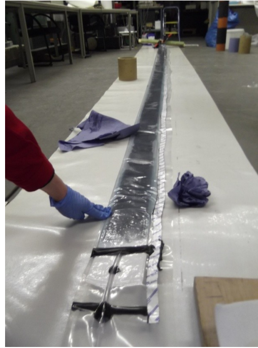
Abb. 6-10: Vakuuminfusion des Faserpakets
