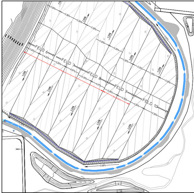
Abbildung 1: Genehmigungsbestand: Basisabdichtung Felder 9+10 (Auszug aus Anlage 1.1)
