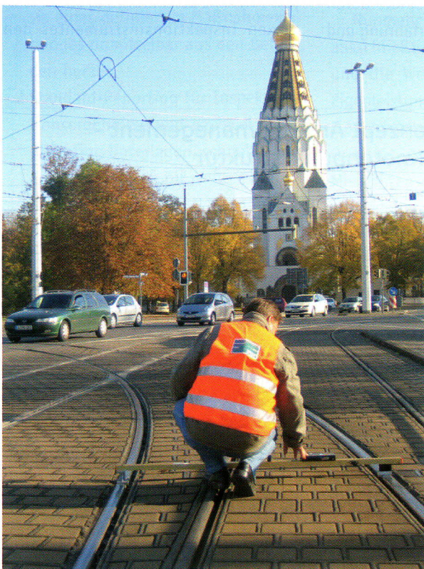
Weichenvermessung mit MessReg®.
