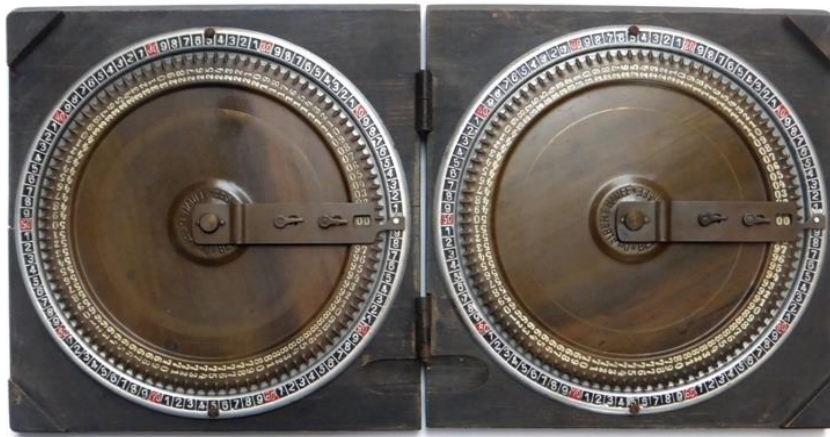
Abb. 41: Doppelrechenmaschine Duplo von Hauff mit Prägung Dr. Albert Hauff – Berlin Halensee
