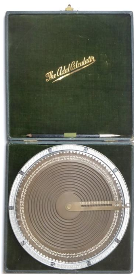
Abb. 43: The Adal Calculator in typischer Box; Variante mit geschlitztem Steg wie Union
