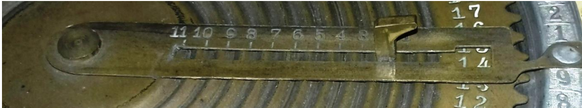
Abb. 24: Neuer kippbarer und damit verschiebbarer Zeiger bei Autorechner , Unikum und Union
