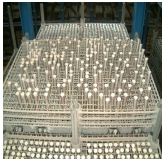
Bild 13: Senkrecht hängendes Nitrieren verzugempfindlicher Ausgleichsbolzen aus 31CrMoV9
