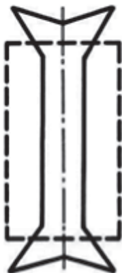
Bild 4: Formänderung eines Zylinders durch Umwandlungsspannungen
