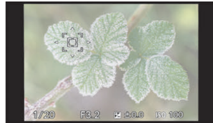
Abbildung 4.7 Findet die Kamera innerhalb des kleineren Fokussierrahmens keinen Schärfepunkt, weitet sie das Feld bei Einstellung von Erweit. Flexible Spot bis zum äußeren Rahmen aus.
