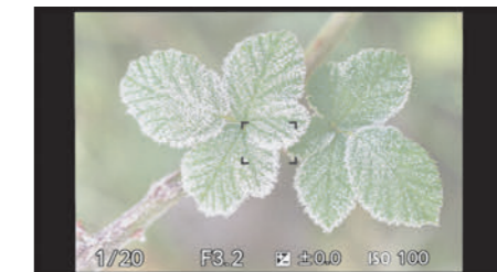
Abbildung 4.5 Wählen Sie das Fokusfeld Mitte, wenn Sie die Schärfe zwischenspeichern und anschließend den Bildausschnitt verändern möchten.
