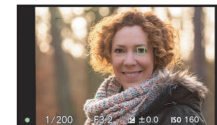
Abbildung 4.27 Bei erfolgreicher Scharfstellung leuchtet entweder der Gesichtsrahmen oder der kleinere Rahmen des Augen-AF grün.
