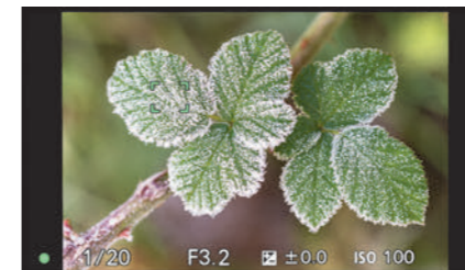
Abbildung 4.1 Bei erfolgreicher Scharfstellung leuchten die aktiven Fokussierrahmen (hier ein einzelner auf dem linken Blatt) sowie der Fokusindikator (unten links) durchgehend grün, und es ist ein Signalton zu hören.
