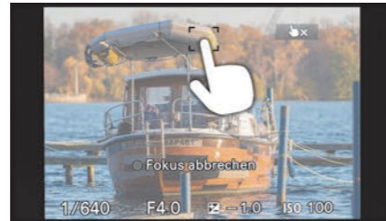
Abbildung 4.12 Den Fokuspunkt mit dem Touch-Fokus setzen und per Auslöser das Bild aufnehmen
