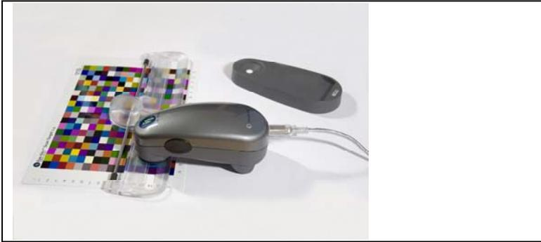
Abbildung 1.14: Vermessen eines gedruckten Test-Charts mit einem Spektralfotometer
