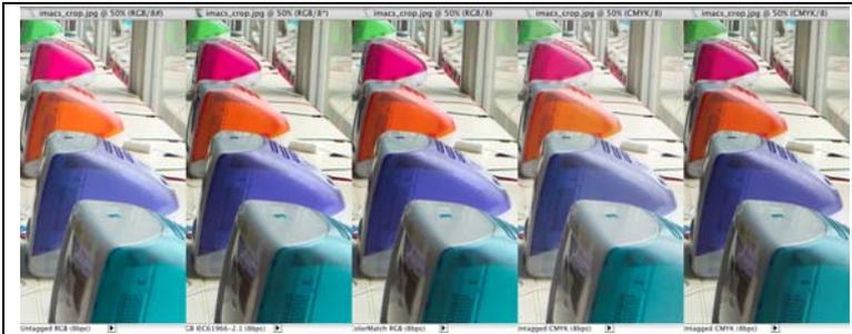
Abbildung 1.8: Visueller Farbraum-Vergleich: Ganz links ist das unprofilierte Original, sRGB, ColorMatch RGB, ein Profil für den Druck mit starkem Schwarzaufbau und ganz rechts für den Druck nach ISO coated.
