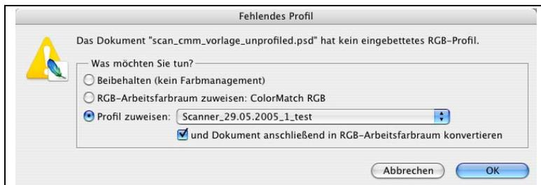
Abbildung 1.60: Unprofilierten Scan öffnen
