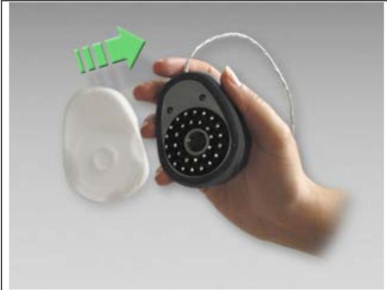
Abbildung 1.22: Umgebungslicht-Messung, hier mit Eye-One Display 2
