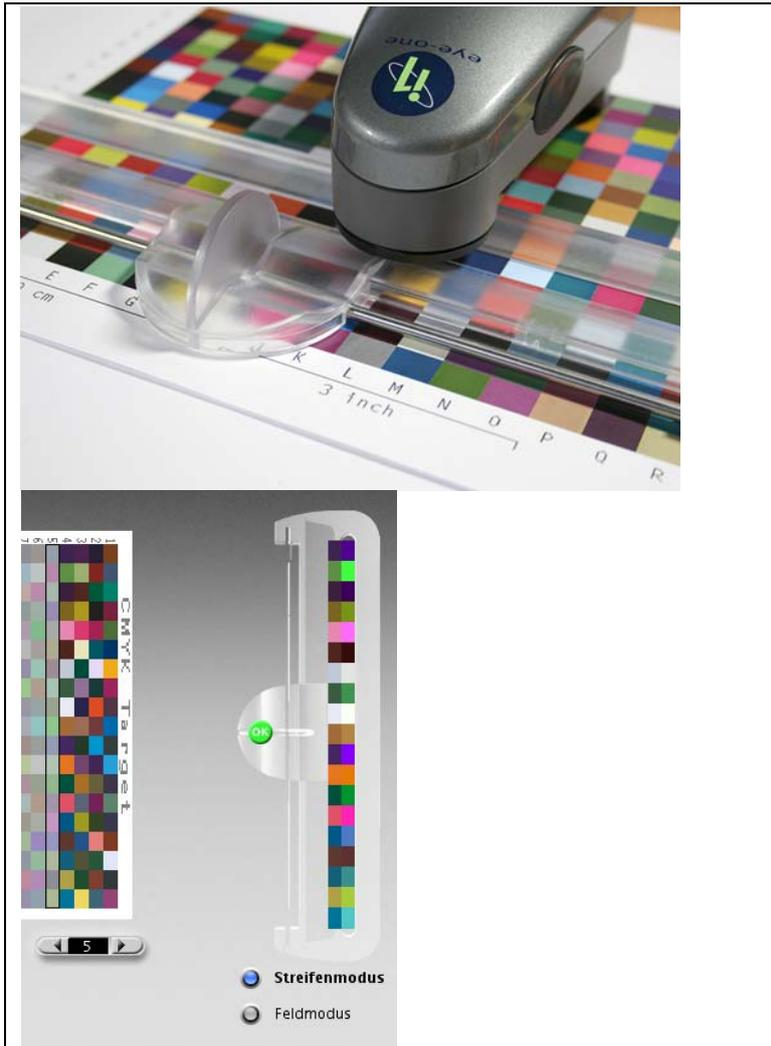
Abbildung 1.40: Ausmessen des gedruckten Testcharts und der Messbildschirm
