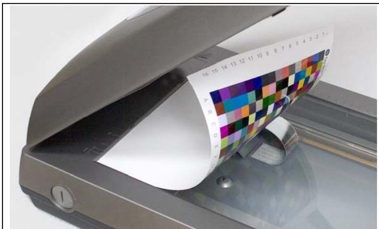
Abbildung 1.32: Scanner mit Kalibrierungs-Target
