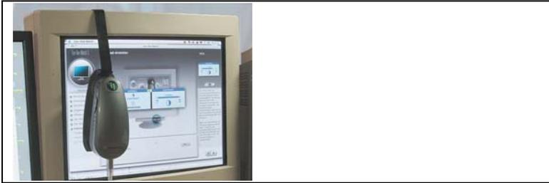
Abbildung 1.24: Eye-One Pro-Messgerät am Monitor
