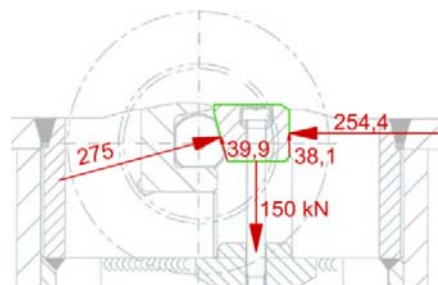
Abbildung 4: Reaktionskräfte am Spannkeil durch Schraubenvorspannung ( \mu=0,15 )
