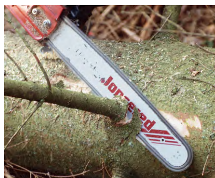
Ergonomisch und sicherheitstechnisch korrekte Stellung beim Entasten: die Motorsäge liegt auf dem Stamm auf, nie mit der Schwertschneidkante schneiden.
