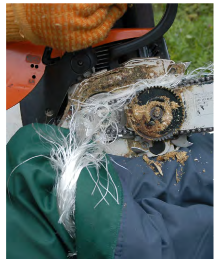
Die Beine sind durch die Motorsäge am meisten gefährdet. Der Motorsägeföhrer ist verpflichtet, Sicherheitshosen mit Schnittschutzeinlagen zu tragen. Der langfaserige Schnittschutz blockiert die Kette innert Sekundenbruchteilen.
