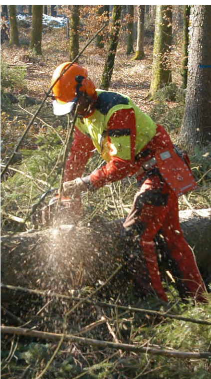
Ergonomisch und sicherheitstechnisch korrekte Stellung beim Entasten: die Motorsäge liegt auf dem Stamm auf, nie mit der Schwertschneidkante schneiden.
