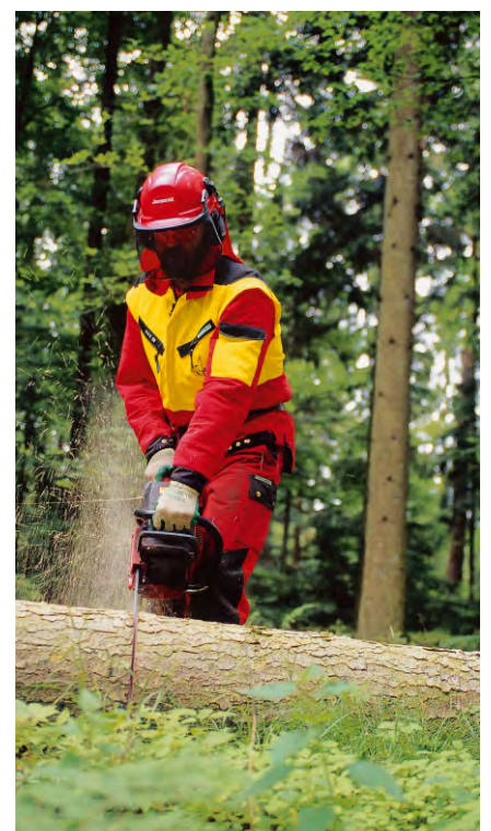
Ergonomisch und sicherheitstechnisch korrekte Stellung beim Entasten: die Motorsäge liegt auf dem Stamm auf, nie mit der Schwertschneidkante schneiden.
