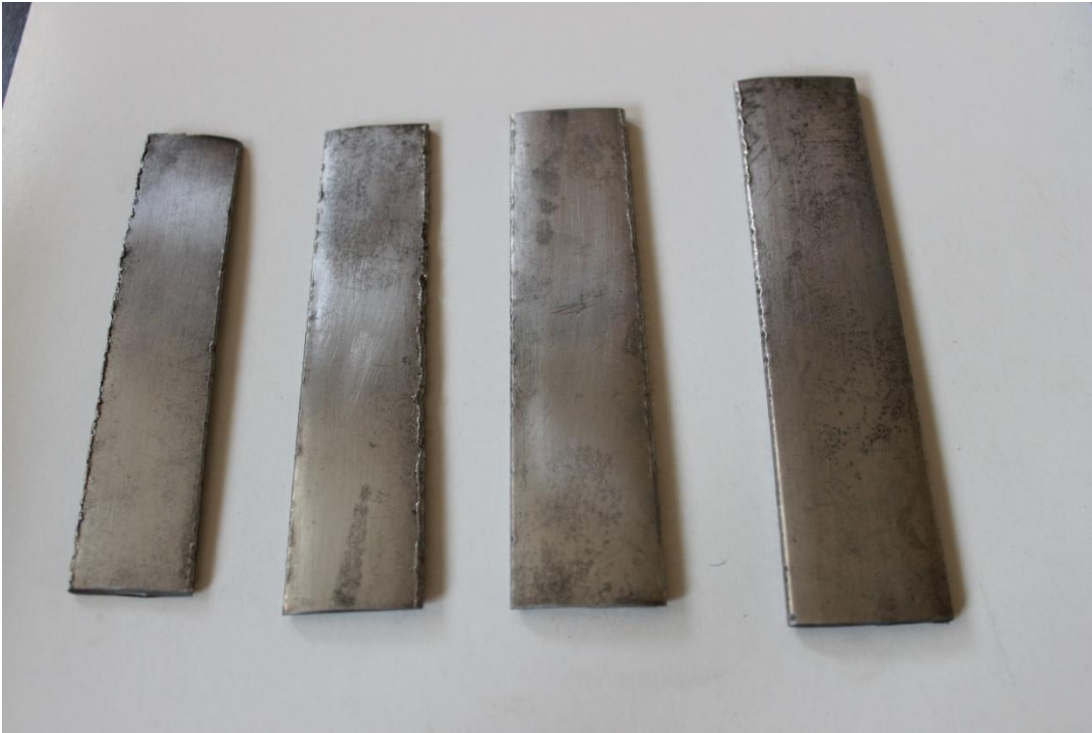
Abbildung 4-18: gebrochene Klingenteile gereinigt
