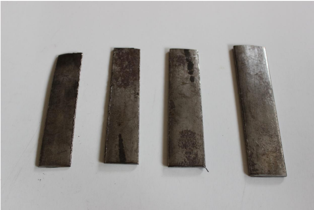
Abbildung 4-17: gebrochene Klingeteile in gebrauchtem Zustand
