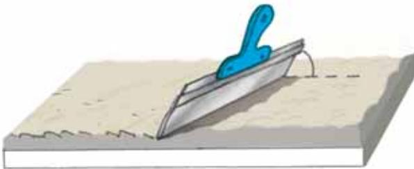
Bei steil gestelltem Werkzeug entstehen mehr Wellen im Untergrund.
