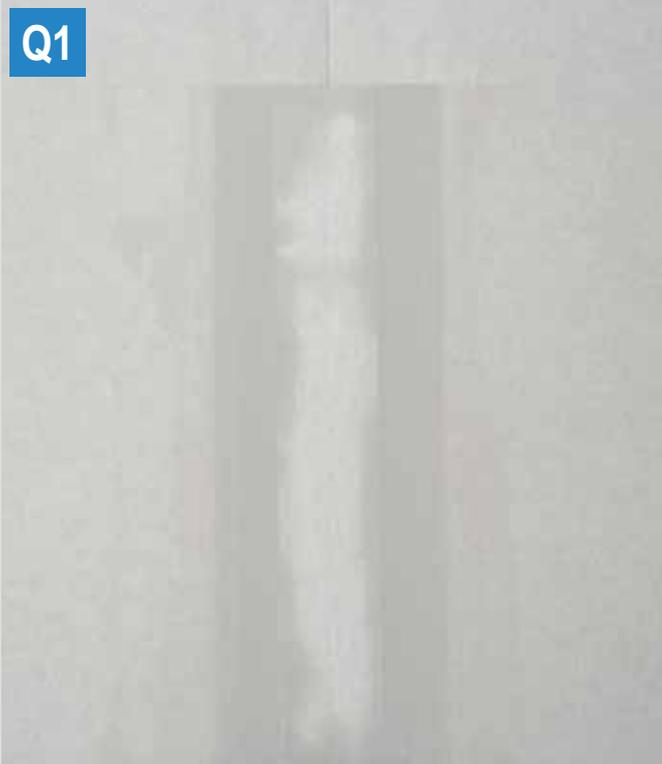
Q1: Knauf TRIAS in AK-Fuge mit Knauf Fugendeckstreifen Kurt (1x gespachtelt).
