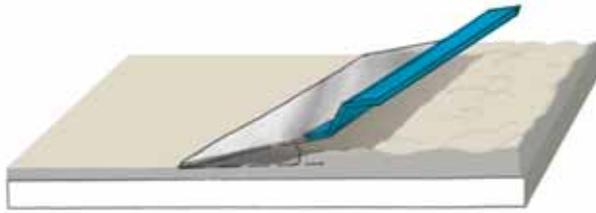
Die Knauf Flächenspachtel kann beidhändig flach angestellt werden. Eine Voraussetzung für optimal ebene Oberflächen, denn die Fläche wird zugezogen, aber kaum Material abgezogen.
