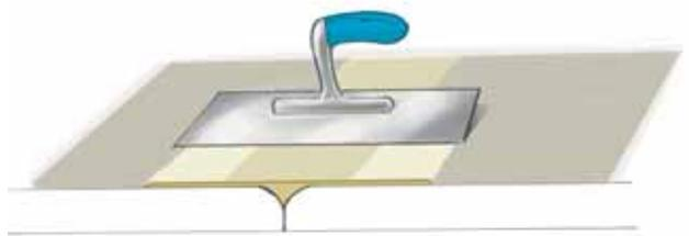
Der lange Steg verhindert, dass sich die Kelle in Längsrichtung durchbiegt und dadurch vertieft gespachtelt wird.
