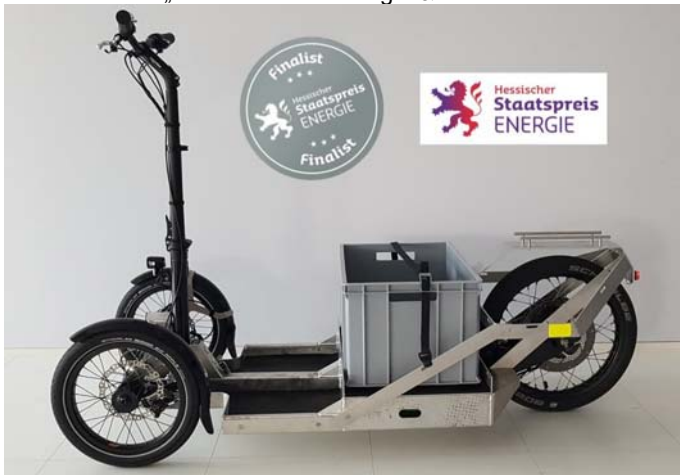
Bild: SurbX, stabiles Elektrokleinstfahrzeug mit Transportbox, Foto: Reck Elektrofahrzeuge
