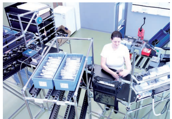
Bild 34: Montage im One-Piece Flow (LEAN)
