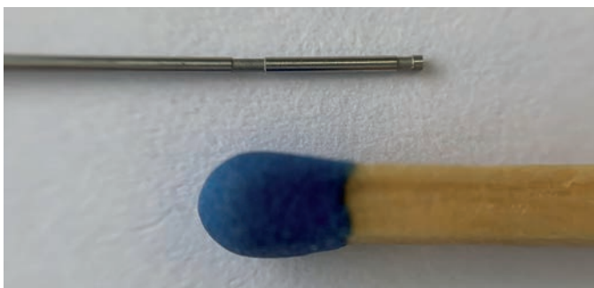
Bild 16: Rotierendes Schneiden mit Indexierung bei \varnothing 0,4 mm mit Genauigkeit von 0,002mm
