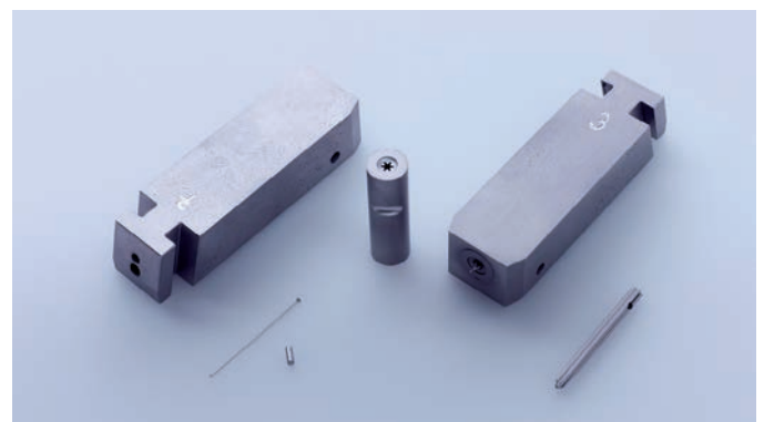
Bild 12: Mikro-Einsatz – für resorbierbare Schraube M1,5
