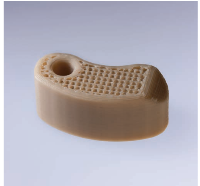
Bild 26: Peek Cages im AM-Verfahren hergestellt
