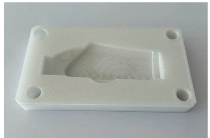
Bild 9: POKA-YOKE Vorrichtung mit AM hergestellt
