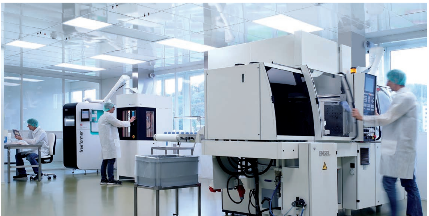
Bild 28: Reinraum (ISO 8) für Prototyping und AM
