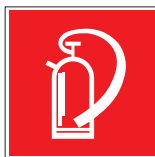
Hinweis auf ein Feuerlöschgerät
