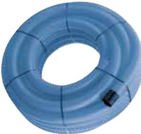
Gewelltes ungelochtes Dränagerohr aus PP; Farbe blau; Ringsteifigkeit  $\geq 10 \text{ kN/m}^2$  („SN 10“); in Anlehnung an DIN 1187 und DIN 4262-1.
