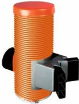
Spül-, Kontroll- und Sammelschacht für fachgerechte Dränanlagen mit FRÄNKISCHE Schal- und Dränprofil (FSD), wahlweise für die Anordnung an Gebäudeaußenecken oder Gebäudeinnenecken, wahlweise mit oder ohne Sandfang, Außendurchmesser  $D_A$  315, Bauhöhe 80 cm, Material PVC-U, Farbe orange, mit 2 Stück Anschlussstutzen für FSD-Profil und 1 Stück Ablaufanschluss DN 200 mit Blindstopfen, mit arretierbarer und trittfester Schachtabdeckung aus PP.
