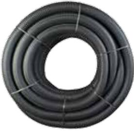
Gewelltes Vollsickerrohr aus PE; Farbe schwarz mit gelber Farbmarkierung; Ringsteifigkeitsklasse SN 8; Schlitzfläche  $\geq 50 \text{ cm}^2/\text{m}$ ; Schlitzbreite 1,2 mm. In Anlehnung an DIN 1187 und DIN 4262-1.
