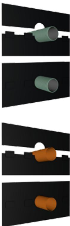
Stabile Kunststoffwand aus PE mit Wandstärke von 10 mm. Die Stauwandschürze wird nach der Rigole und ggf. vor dem Drosselschacht RigoLimit V bzw. AquaLimit in die Wände und Sohle des Rohrgrabens eingebunden. Es wird eine ablaufseitige Abdichtung des Rigolengrabens in Form einer Abflussbarriere geschaffen und damit der unkontrollierte Wasserablauf durch den Rohrgraben verhindert. Die Anwendung erfolgt z. B. in kaskadenförmigen Rigolen.
