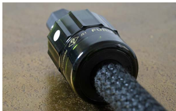
Sowohl am Stecker auch als an der Buchse des HMS Energia Suprema finden sich Phasenmarkierungen (weißer Punkt)
