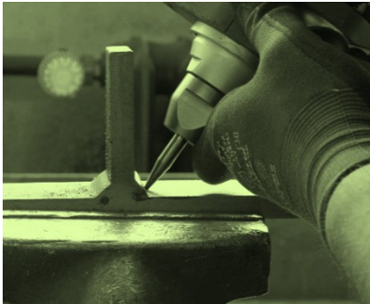
Abbildung 1: Einsatz des HFH-Verfahrens PIT an Klein-Probekörpern und Bauteilprüfkörpern aus [28] zum Kerbdetail der Quersteife
