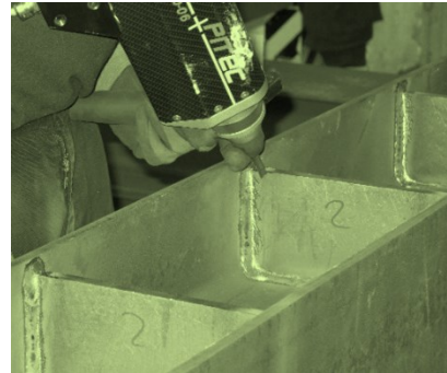
Abbildung 1: Einsatz des HFH-Verfahrens PIT an Klein-Probekörpern und Bauteilprüfkörpern aus [28] zum Kerbdetail der Quersteife
