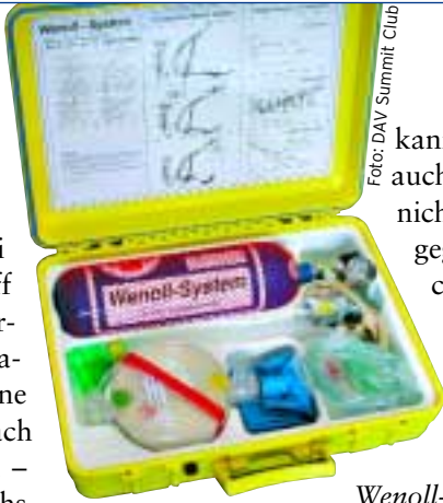
Wenoll-System – Sauerstoffversorgung mit geschlossenem Kreislauf
