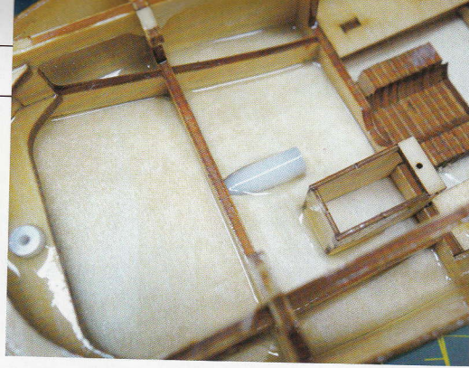
Das Rumpffinnere wurde mit Epoxid versiegelt
