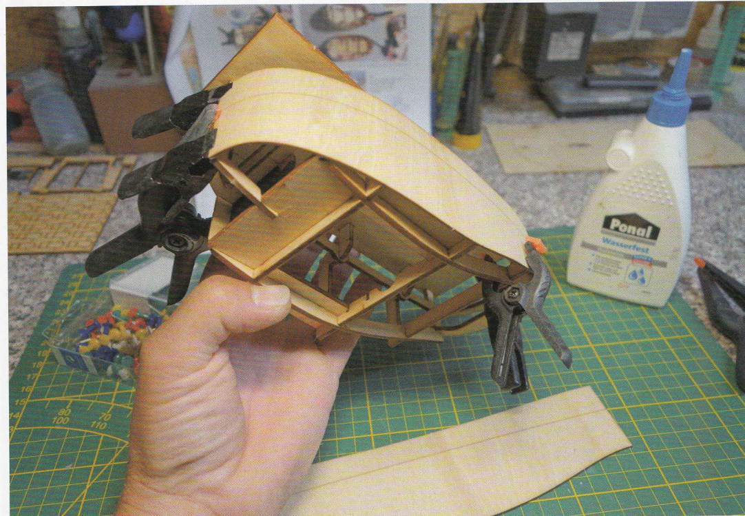
Die Außenhaut aus 1-mm-Sperrholz wird aufgeleimt
