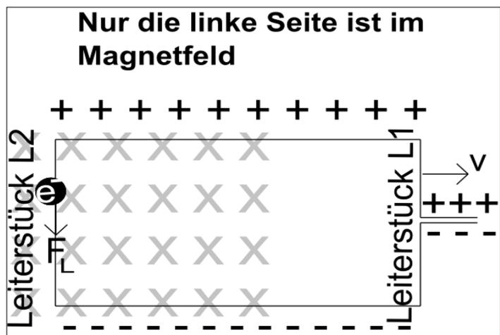
Dieses Mal hat die Spannung allerdings (im Vergleich zur 1. Situation) ein umgekehrtes Vorzeichen, da die Lorentzkraft  $F_L$  dieses Mal die Elektronen hin zum unteren Anschluss der Leiterschleife drückt.
