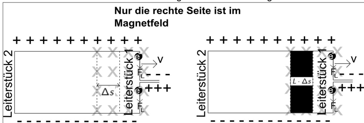
Die Leiterschleife wird nun um eine Strecke von  $\Delta s$  in einer bestimmten Zeit  $\Delta t$  nach rechts gezogen. Daraus ergibt sich eine bestimmte Geschwindigkeit  $v$ , mit der die Leiterschleife gezogen wird. Durch die Bewegung des Leiterstücks 1 durch das homogene Magnetfeld mit der Magnetfeldstärke  $B$ , wird eine Spannung  $U_{\text{Ind}}$  im Leiter induziert. Aus dieser Situation 1 folgt:
