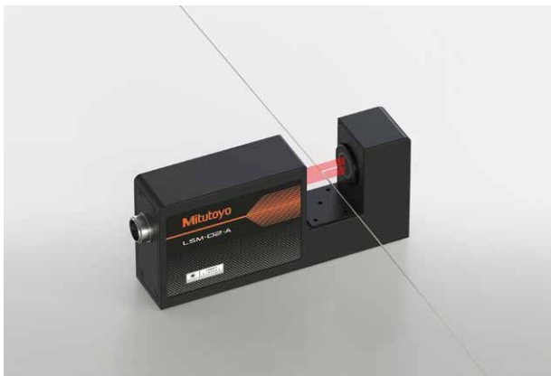
gleichzeitige Messung des Außendurchmessers und der Durchbiegung von Walzen
