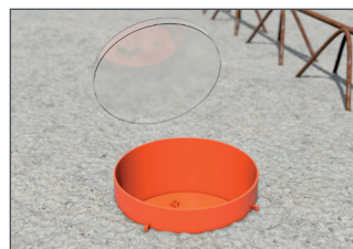
Schutzdeckel auf der Baustelle entfernen
