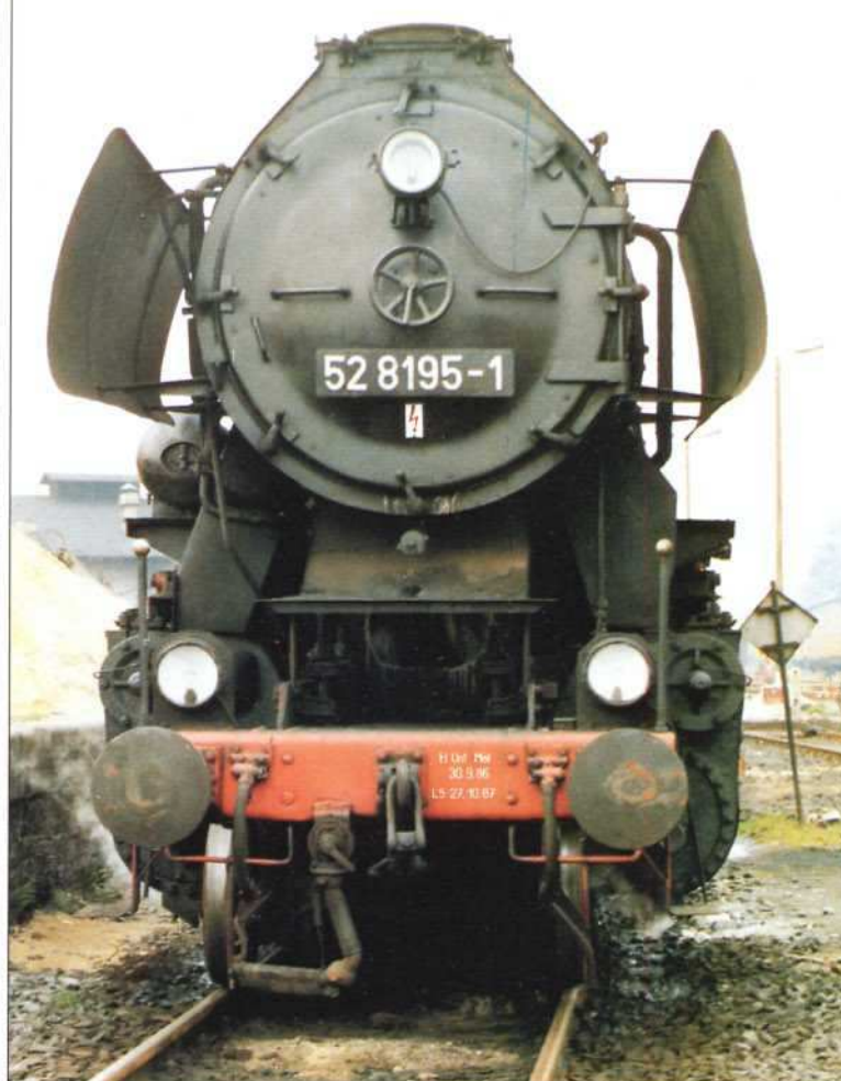
Bild 11: Die bestens gepflegte und voll betriebsfähige 52 8195 ist Heizlokomotive im Bw Zittau. Die letzte L 7 (früher L 4 = Hauptuntersuchung) bekam sie am 30. September 1986, die letzte L 5 (Zwischenausbesserung) am 27. Oktober 1987.
