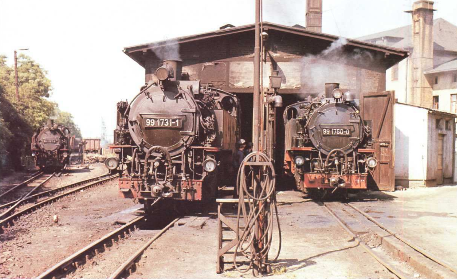
Bild 2: Der Lokschuppen für die Schmalspurlokomotiven ist zweistöckig und hat vor der Einfahrt in jedem Gleis eine Untersuchungsgrube. Vor dem Schuppen stehen die Einheitslokomotiven 99 731 und 99 760 einsatzbereit; die 99 757 rangiert an der Rollwagengrube.
