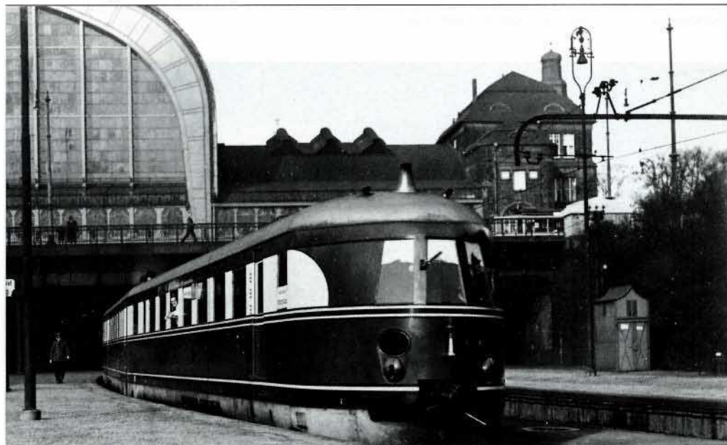
Bild 6: Ein weiterer Schritt in der Einführung des Schnellverkehrs war die Entwicklung der dreiteiligen Triebwagen der Bauart Leipzig. Die Aufnahme zeigt einen der vier gebauten Triebwagen um 1935 in Hamburg. Foto: Sammlung Weisbrod
